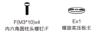
1、把电机放置在机臂安装电机的孔位上，对准螺丝孔距，用4颗M3内六角圆柱头螺钉将电机锁紧在机臂上。如图所示
