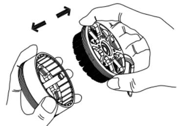
3、端盖轴承拆卸方法：双手把电机定子组件端平，轴承端面正对上方，另一人把轴承拆卸顶杆小端从轴承孔内放入，倾斜10度左右顶住靠安装面端轴承的一个边缘，手抓住顶杆，用橡胶锤轻敲轴承拆装顶杆；然后换到另一边，再敲击，两侧平衡敲击，如此循环动作，使轴承顺畅的从轴承孔内掉落出来。如图所示。
