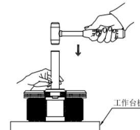
4-1、端盖轴承安装方法：将安装好一面轴承的定子组件水平放置在工作台上，用轴承安装顶杆固定好轴承，与轴承安装孔对齐，轴承与安装面保持平行，用橡胶锤轻轻敲顶杆，直到轴承安装到位。如图所示。
