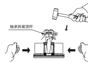
3-1、端盖轴承拆卸方法：将拆完一端轴承的定子组件，反面朝上端平，轴承端面正对上方，另一人把顶杆的小端垂直放在轴承端面上，手抓住顶杆，用橡胶锤轻敲轴承拆装顶杆；然后换到另一边，再敲击，两侧平衡敲击，如此循环动作，使轴承顺畅的从轴承孔内掉落出来。如图所示。
