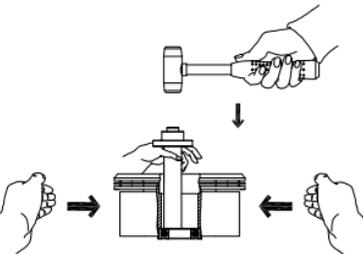
4、端盖轴承安装方法：准备好相同规格的轴承，然后将拆完轴承的定子组件水平放置在工作台上，下面用细软的材料垫起，保护漆包线不得受伤，或者用平整得垫片避开漆包线，垫起轴承部位。用轴承安装顶杆，与轴承内孔相匹配的一端，固定好轴承，放置在定子轴承孔内。轴承与安装面保持平行，确保与轴承孔同轴，用橡胶锤轻轻敲顶杆，直到轴承安装到位。如图所示。
