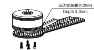
2、把螺旋桨的中心孔与电机端盖定位轴对齐放置，最后用4颗M3\*10内六角沉头螺钉将螺旋桨压板和螺旋桨锁紧在电机端盖上。如图所示
