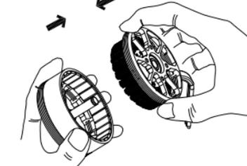
5、检查电机定子组件和转子组件在拆卸过程中是否有异物粘附在上面。手分别握住电机的定子组件和转子组件，转子组件上的轴对准定子组件上的轴承内孔，轻轻插入，保持同心，直到轴在定子组件的另
