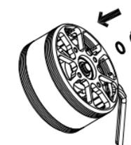
6、装配好电机定子组件和转子组件后，在露出卡簧槽的轴端依次装入挡圈、卡簧、锁轴垫片；最后在取出的3颗M3内六角沉头螺钉上蘸取适量螺丝胶后用内六角扳手将锁轴垫片锁紧，如图所示
