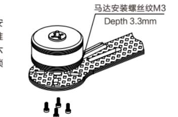
2、把螺旋桨固定座螺纹端朝上，固定底座端孔对齐电机端盖的定位轴，用4颗M3\*5内六角圆柱头螺钉将固定座锁紧在电机上；然后把螺旋桨的中心孔与螺旋桨固定座定位轴对齐放置，再把螺旋桨垫片对齐固定座放置在螺旋桨上，最后用螺帽旋入螺旋桨固定座锁紧。如图所示
